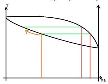
On remarque qu'une distillation simple ne permet pas d'isoler le composé volatil pur dans le distillat. On ne peut pas vraiment isoler B pur cependant.
